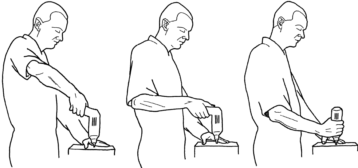
Figur 8. Pistolhandtag med en vinkel mellan handtag och överdel på 110° och 90° samt ett rakt verktyg, som används vid bearbetning av en horisontell yta på ett arbetsstycke som ligger på en arbetsbänk. Det raka verktyget ger den bästa arbetsställningen och det som har en vinkel på 110° ger den sämsta.
